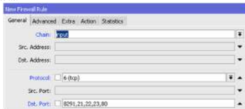
Gambar 9. Block port selain dari IP yang masuk daftar list
